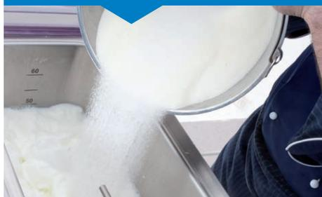
**Couvercle et pompe échangeur :** Grâce à l'absence d'agitateur dans la cuve, il est possible d'introduire des ingrédients en ouvrant le couvercle (pendant que le mélange est en agitation) en travaillant en toute sécurité.
